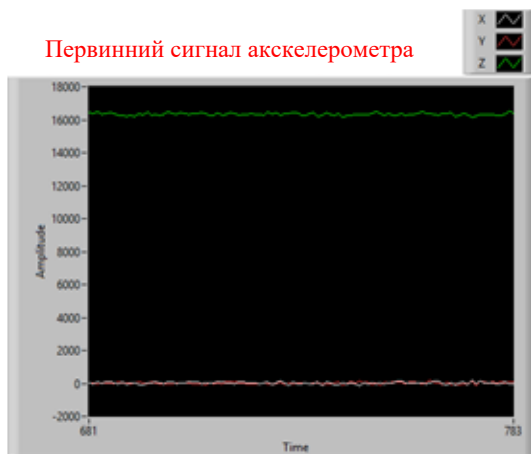
Рис. 7.3 Сигнали акселерометрів модуля MPU-6050: а) первинний сигнал; б) сигнал без зміщення нуля та шуму
