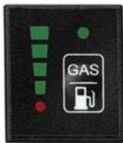
Рис.2.3. Салонний індикатор призначений для системи STAG 200 GoFast
