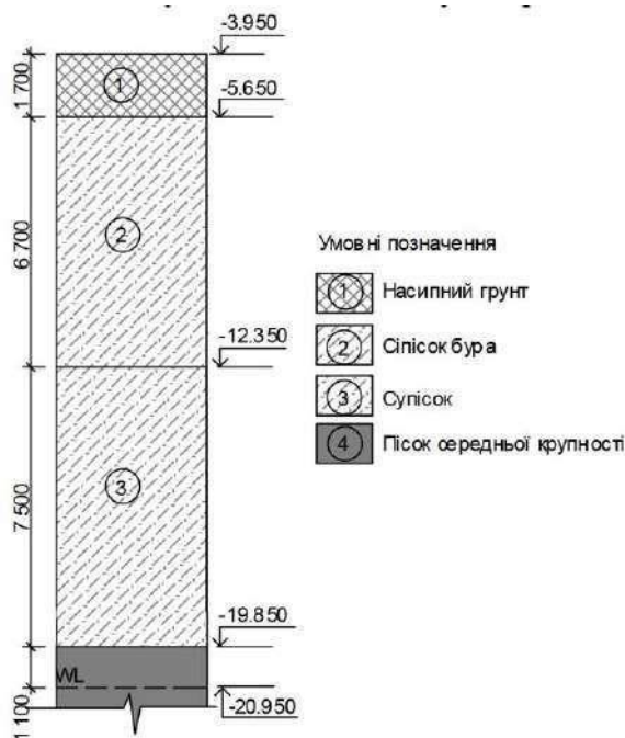
Рисунок 3.1 - Інженерно-геологічний розріз будівельного майданчику
