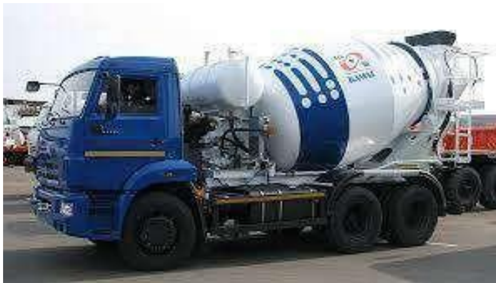
Рисунок 4.1 – Автобетонозмішувач АБС СБ-197 DA на базі Камаз-65115
