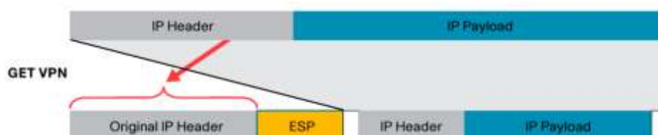
Рисунок 1.4 – Збереження заголовку в GET VPN
