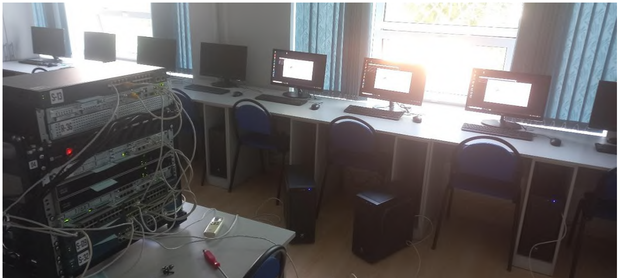
Рисунок 2.6.67 – Тестовий стенд з підключеними імітація глобальних ресурсів у вигляді трьох робочих станцій
