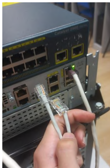
Рисунок 2.6.31 – Розрив фізичних з'єднань між маршрутизатором R-8-11-1 та комутатором SW-8-11-1
