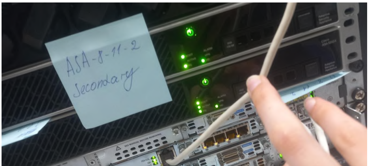
Рисунок 2.6.41 – Стан міжмережеви екранів до спрацювання Failover. Активний вузол – ASA-8-11-1
