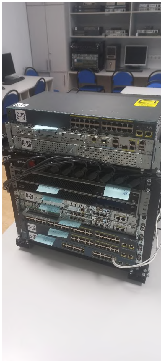
Рисунок 2.4.3. – Тестовий стенд проекту високонадійного захищеного мультитипровайдерного Інтернет-підключення кампусної мережі організації
