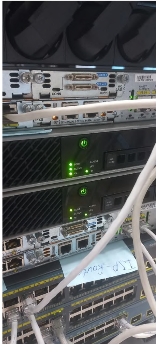
Рисунок 2.6.42 – Стан міжмережеви екранів після спрацювання Failover.
