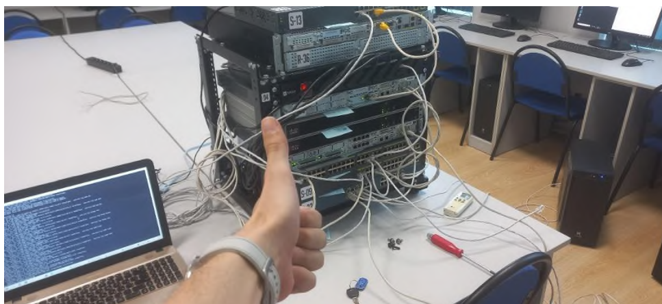
Рисунок 2.1.11 – Результат успішного тестування роботи ручного налагодження метрик маршрутів протоколу OSPF на фізичному стенді.
