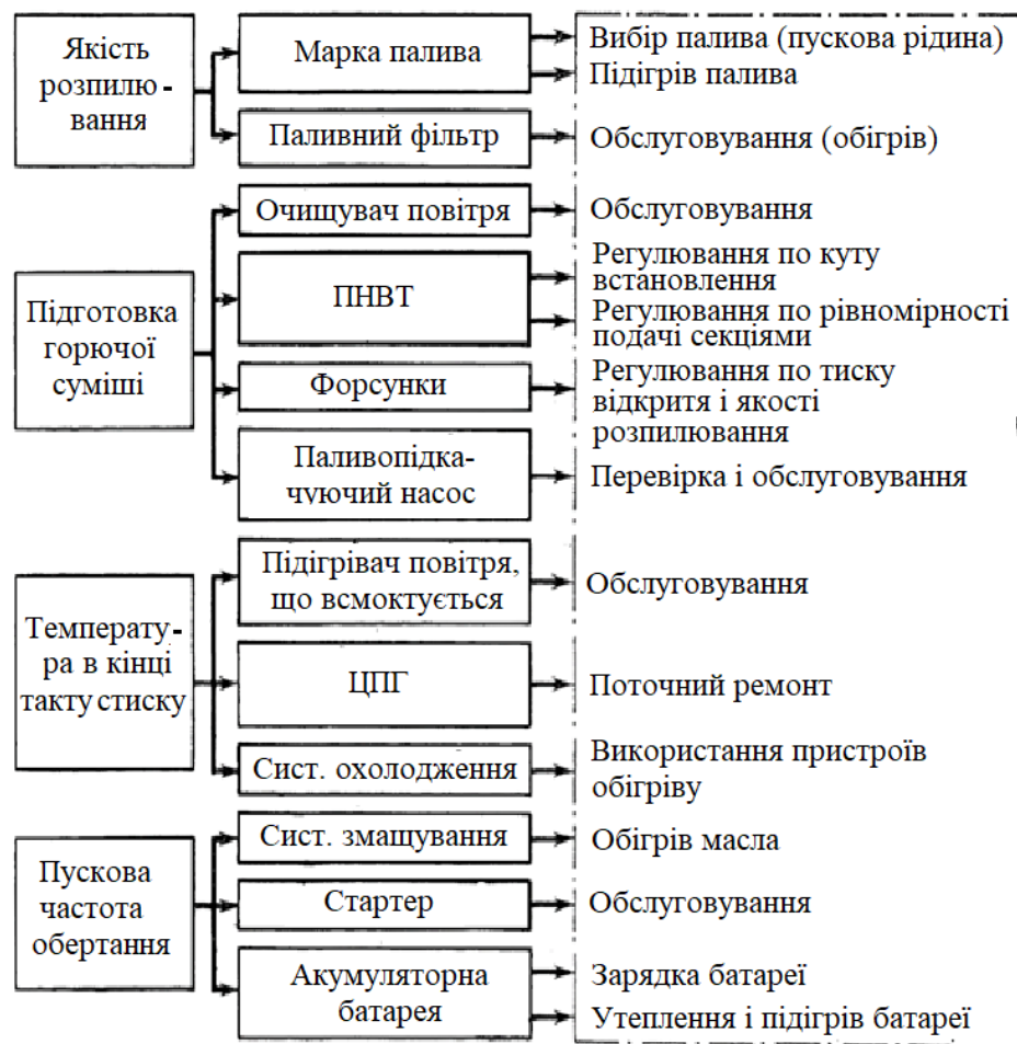
Рис 2.6. Фактори, що впливають на займання суміші в початковий період пуску (пунктиром виділено чинники, якими можна керувати в експлуатації)
