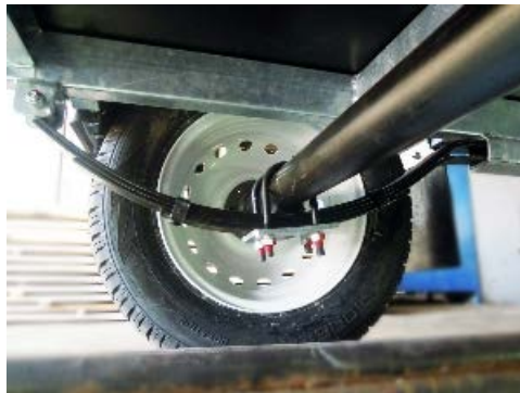
Рис. 1.5. Ресорна підвіска для причепів
