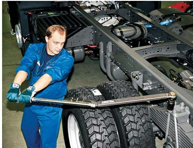
Рис. 1.9. Затягування стрем'янок ресор
