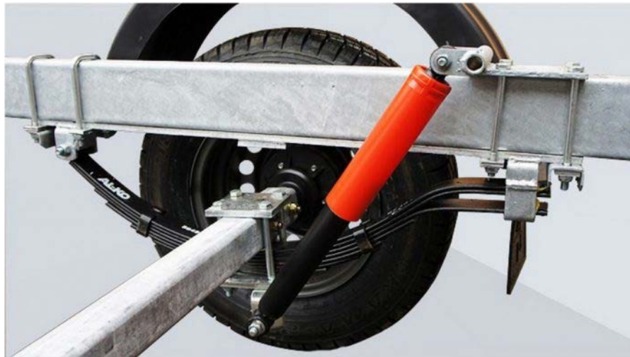
Рис. 1.1. Ресорна підвіска з амортизатором
