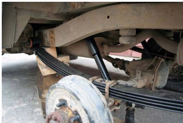
Рис. 1.10. Встановлення автомобіля на дерев'яні колодки для обслуговування підвіски
