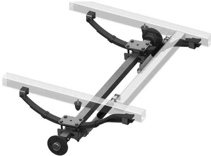
Рис. 1.3. Конструкція ресорної підвіски
