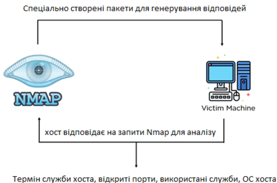
Рисунок 2.5 – Принцип роботи утиліти Nmap
