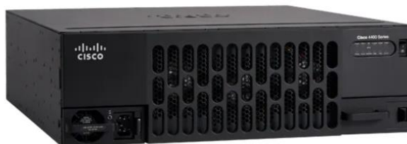
Рисунок 2.7. Маршрутизатор останньої серії (Cisco 4000 Series Integrated Services Routers)
