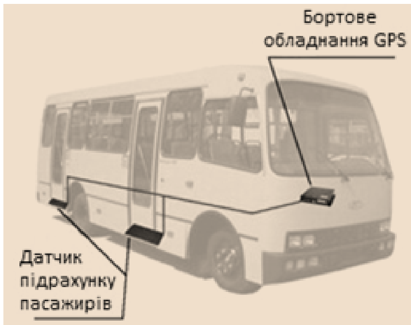
Рис. 3.2. Монтажна схема системи підрахунку пасажирів з датчиками хідникового типу.
