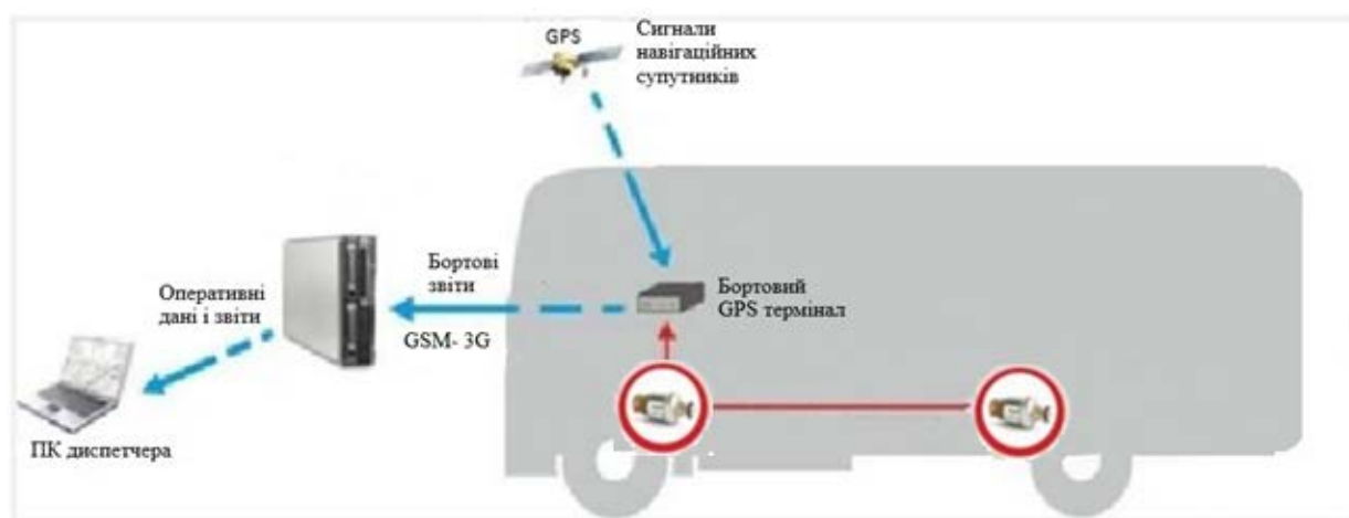
Рис. 3.8. Схема роботи системи контролю датчика тиску навантаження на вісь
