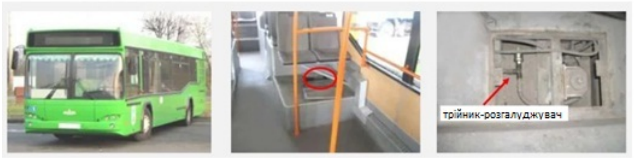
Рис. Місце монтажу трійника -розгалужувача на автобус МАЗ 103.
