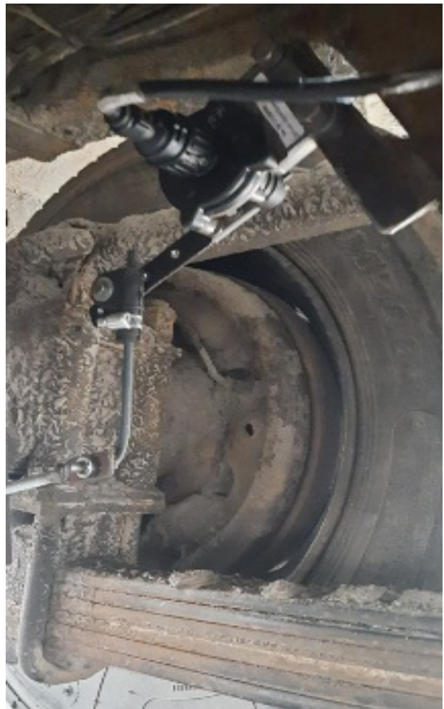
Рис 3.6. Монтаж датчика на вісь автобуса Атаман ISUZU
