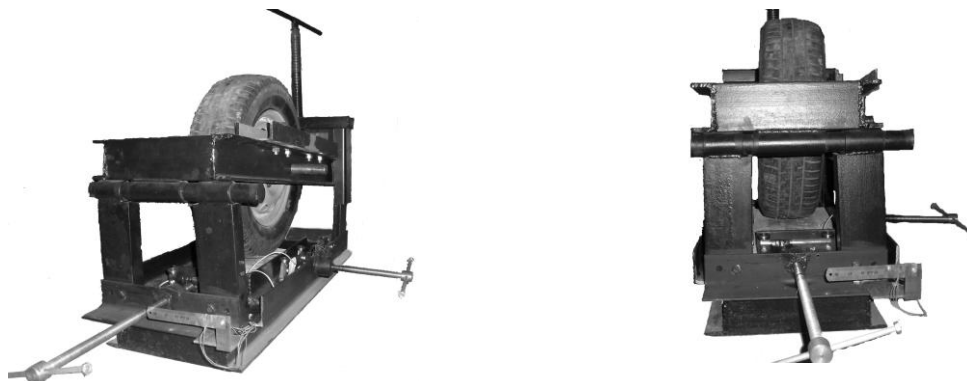
Загальний вигляд експериментальної установки для вимірювання пружних характеристик пневматичної шини.
